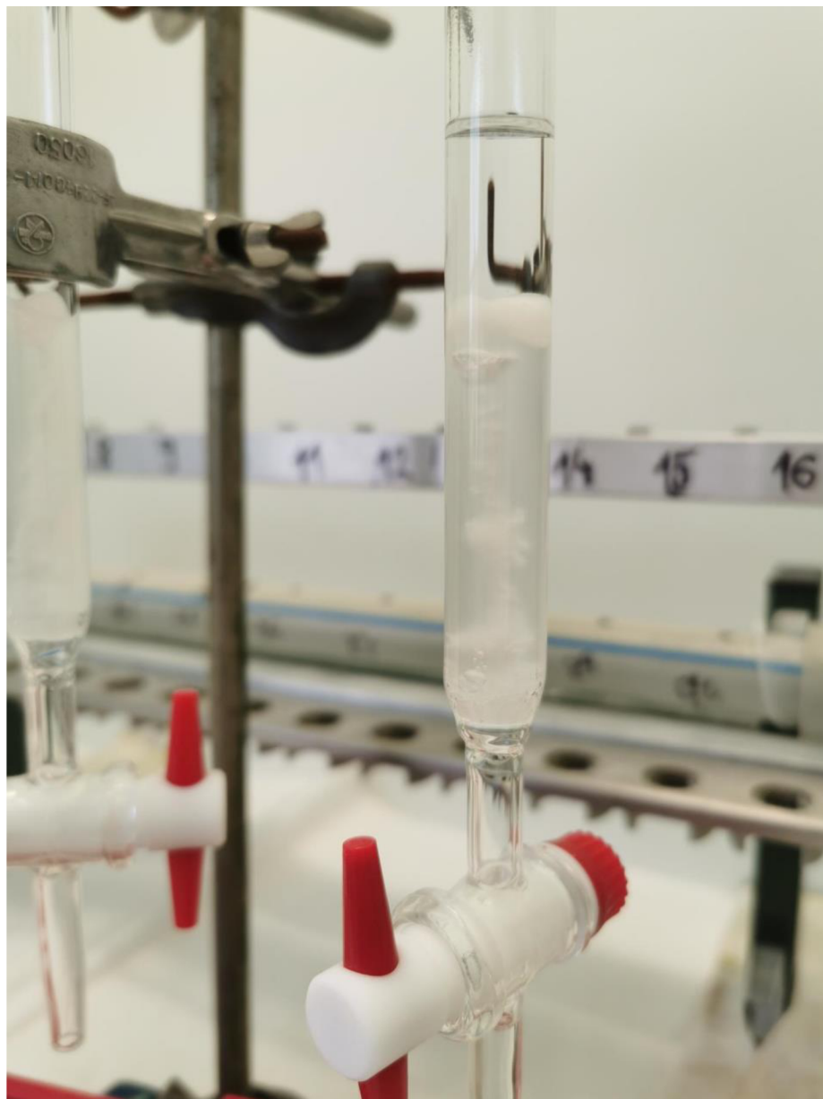
Příloha 1: Naplněná kolonka s narušeným sloupcem silikagelu.
