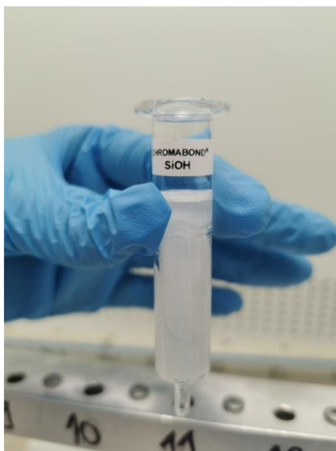
Obrázek 30: Komerční skleněná silikagelová kolonka Chromabond po kondicionaci, z obrázku je viditelné narušení silikagelového sloupce.
