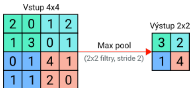
Obrázek 7: Ukázka max pooling vrstvy, kde je dimenze obrázku snížena ze 4x4 pixelů na 2x2 pixelů. Z každé barevné čtvercové matice je použita maximální hodnota.
