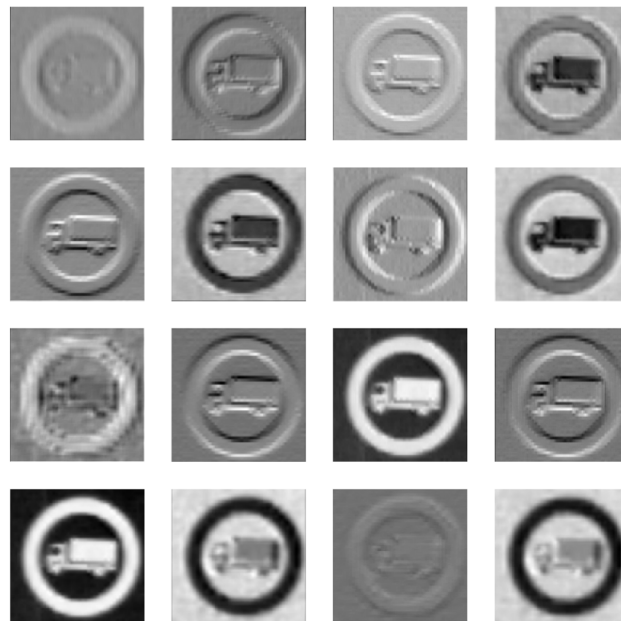
Obrázek 22: Ukázka 2D aktivační mapy VGG16 po průchodu první konvoluční vrstvou (pouze průchod prvních 16 kernelů)
