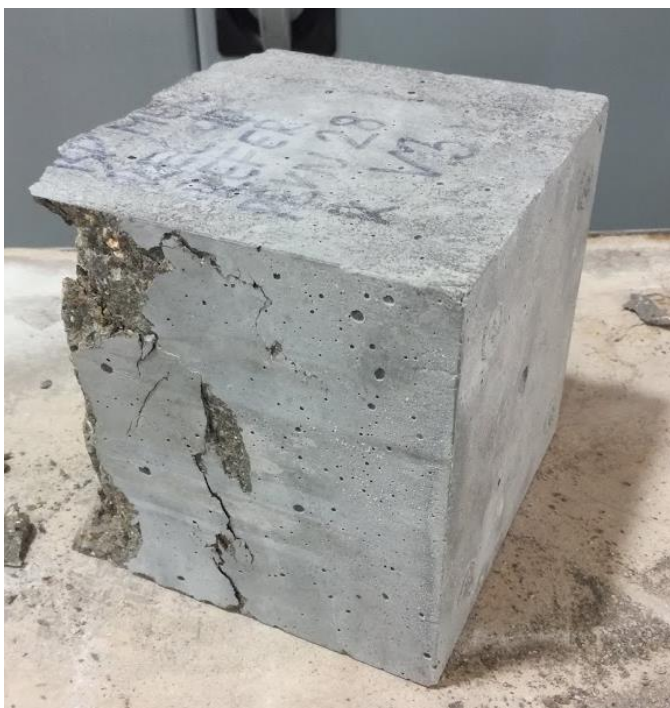
Obr. 23: Porušení zkušebních těles po zkoušce stanovení pevnosti dle ČSN EN 12390 – 3 [N6] – neporušená dolní vrstva
