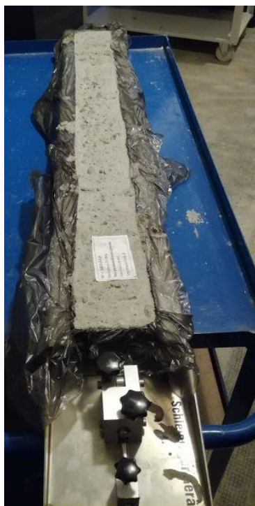
Obr. 27: Měření objemových změn betonové směsi a cementové pasty
