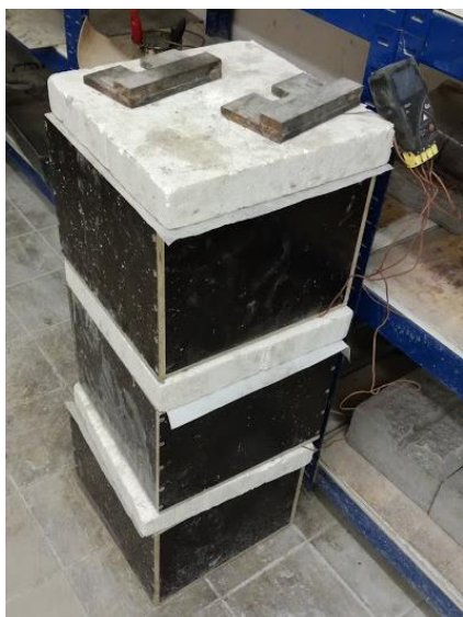
Obr. 25: Měření vývoje hydratačních teplot u betonu a cementových past
