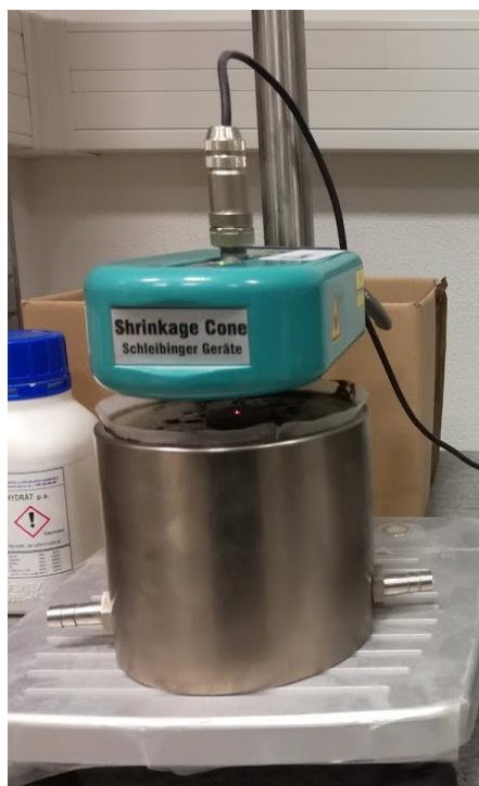
Obr. 27: Měření objemových změn betonové směsi a cementové pasty
