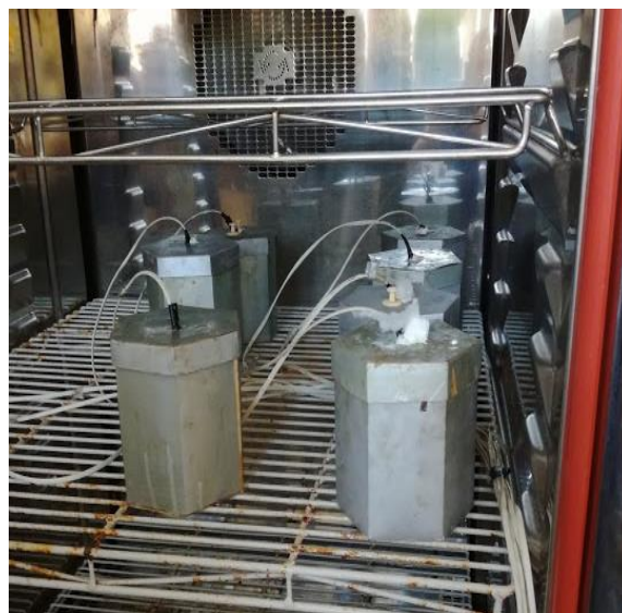
Obr. 25: Měření vývoje hydratačních teplot u betonu a cementových past
