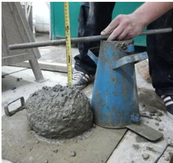
Obr. 24: Stanovení konzistence betonu metodou sednutí kužele dle ČSN EN 12350 – 2 a cementové pasty pomocí střešacího stolku dle ČSN EN 1015 – 3
