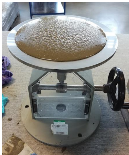
Obr. 24: Stanovení konzistence betonu metodou sednutí kužele dle ČSN EN 12350 – 2 a cementové pasty pomocí střešacího stolku dle ČSN EN 1015 – 3
