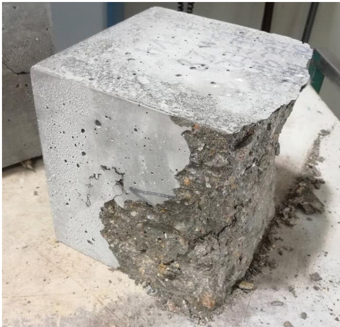
Obr. 22: Porušení zkušebních těles po zkoušce stanovení pevnosti dle ČSN EN 12390 – 3 [N6] – porušená horní vrstva
