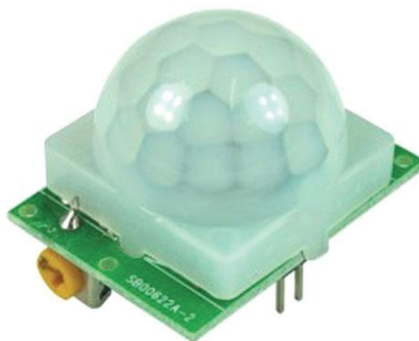
Obrázek 1.2: PIR senzor s usměrňovací čočkou
