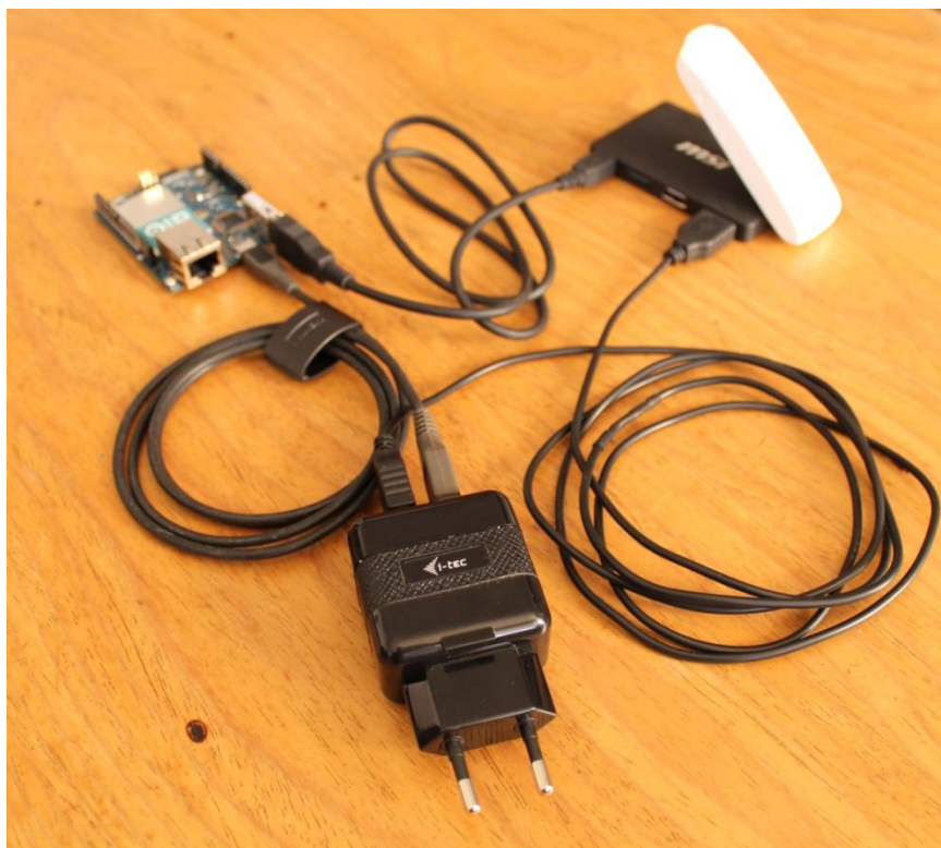
Obrázek 6.7: Pomocné napájení USB modemu
