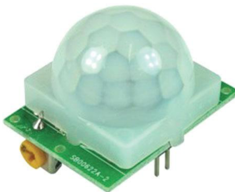
Obrázek 1.2: PIR senzor s usměřňovací čočkou
