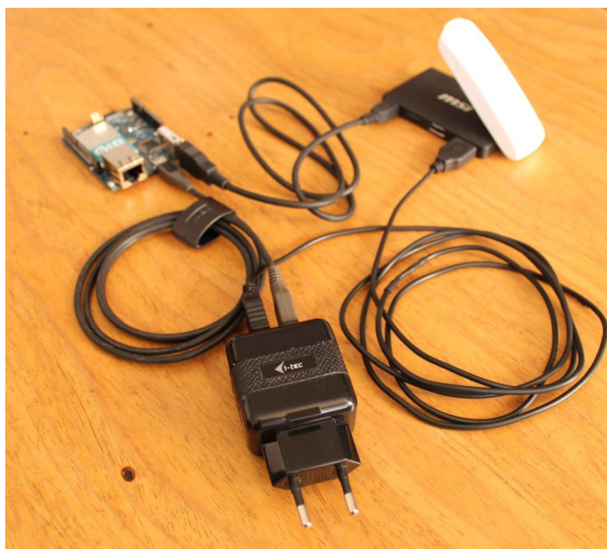
Obrázek 6.7: Pomocné napájení USB modemu
