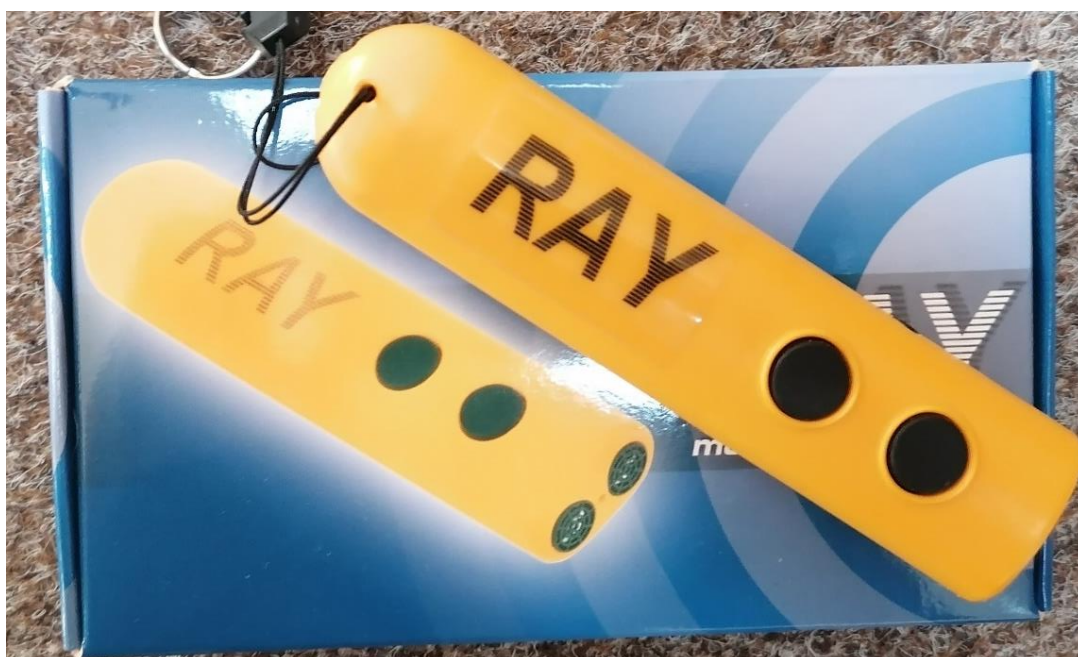
Obr. č. 16 – Ultrazvuková orientační pomůcka RAY.
