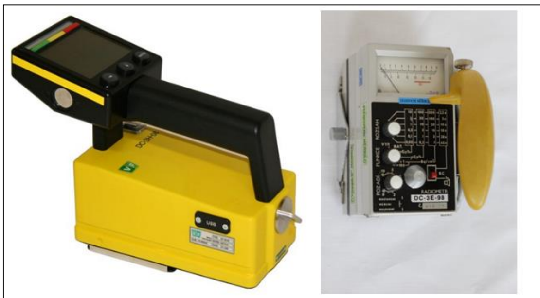
Obrázek 4 Zásahové radiometry DC-3H-08 (31), DC-3E-98 (vlastní zpracování)
