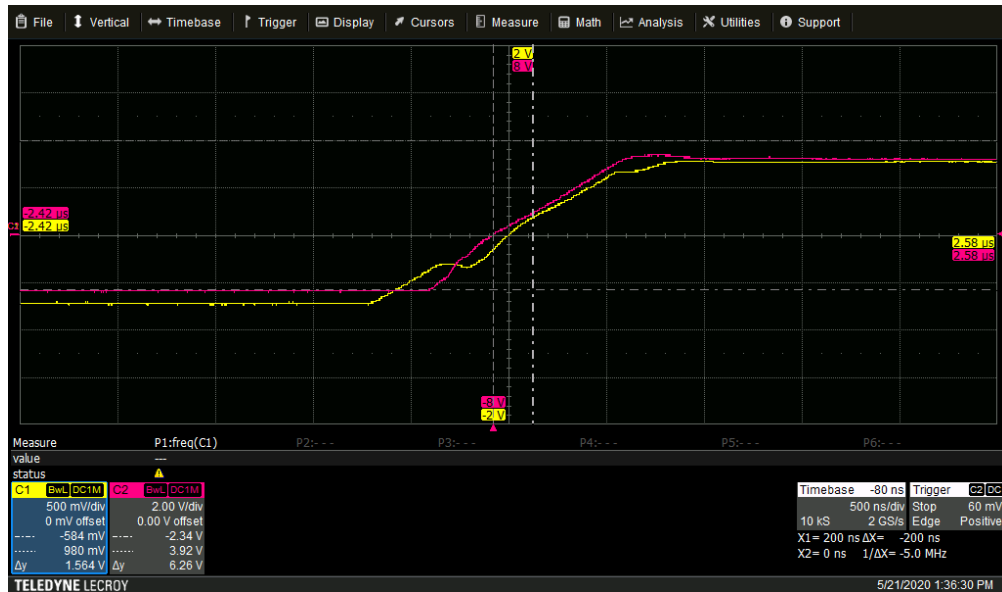
Obrázek 11: Výstupní signál zesilovače LT1210 (C2 – růžová) a vstupní signál (C1 – žlutá) při zatížení výstupu kapacitou 100\text{ nF}
