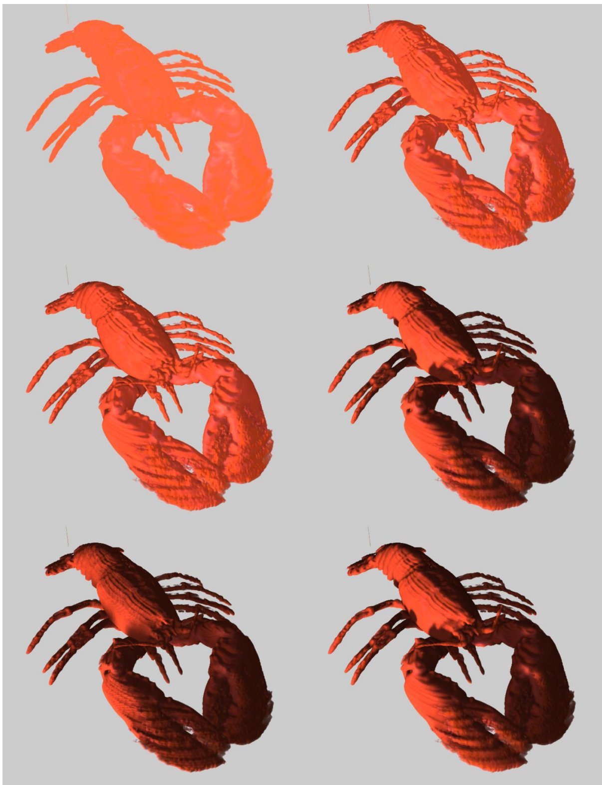
Obrázek 31 – Vliv osvětlovacích metod na výslednou kvalitu obrazu pro dataset Lobster. Vlevo nahoře: žádný osvětlovací model. Vpravo nahoře: lokální osvětlovací model s difúzní složkou Phongova modelu. Vlevo uprostřed: Phongovo stínování a ambient occlusion. Vpravo uprostřed: stínování a vržené stíny trasováním kužele. Vlevo dole: stínování a vržené stíny předpočítáním stínového objemu. Vpravo dole: stínování, stíny a AO metodou trasování kužele.
