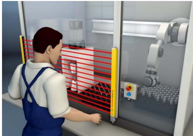
Obr. 20 Využití světelné závory jako bezpečnostního prvku [20]
