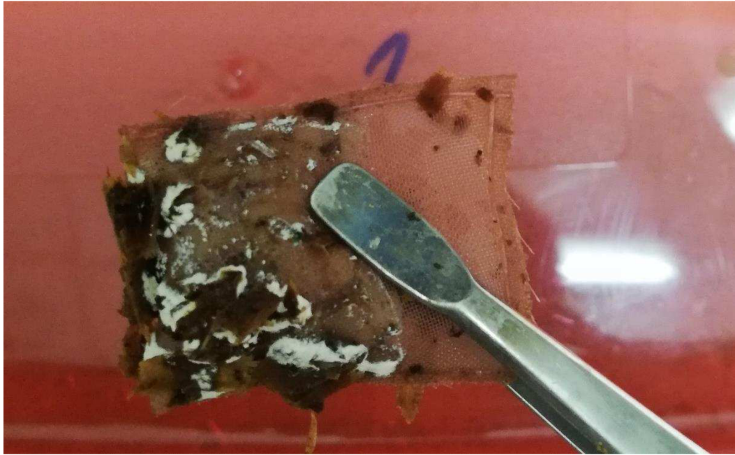
Obrázek 14 – rozvoj plísní na povrchu pytlíku s PHB v první polovině 3. týdne (druhý kompostovací test, reaktor 2)
