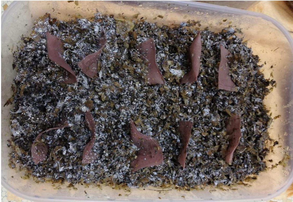
Obrázek 13 – rozvoj plísňových kultur v reaktoru 1 (prvního kompostovacího testu) ve 3. týdnu testu
