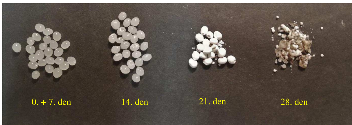
Obrázek 19 – průběh degradace semi-krytalického PLA v druhém kompostovacím testu (po prvních 7 dnech nebyla pozorována žádná změna vzhledu materiálu)
