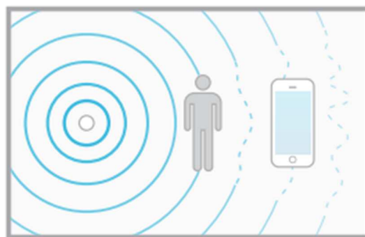
Obrázek 1 Rušení signálu lidským tělem
