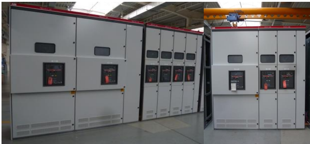
Emaxové rozvaděčové pole
