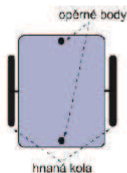
Obr. 3 Schématický náčrt diferenciálního podvozku. [8]
