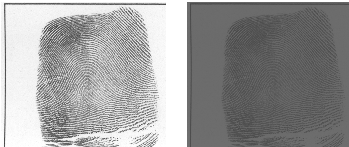
Obrázek 5.6: Porovnání testovacího otisku (vlevo) s aplikací normalizovaným otiskem (vpravo). Použité hodnoty: střední hodnota = 100, rozptyl = 100.
