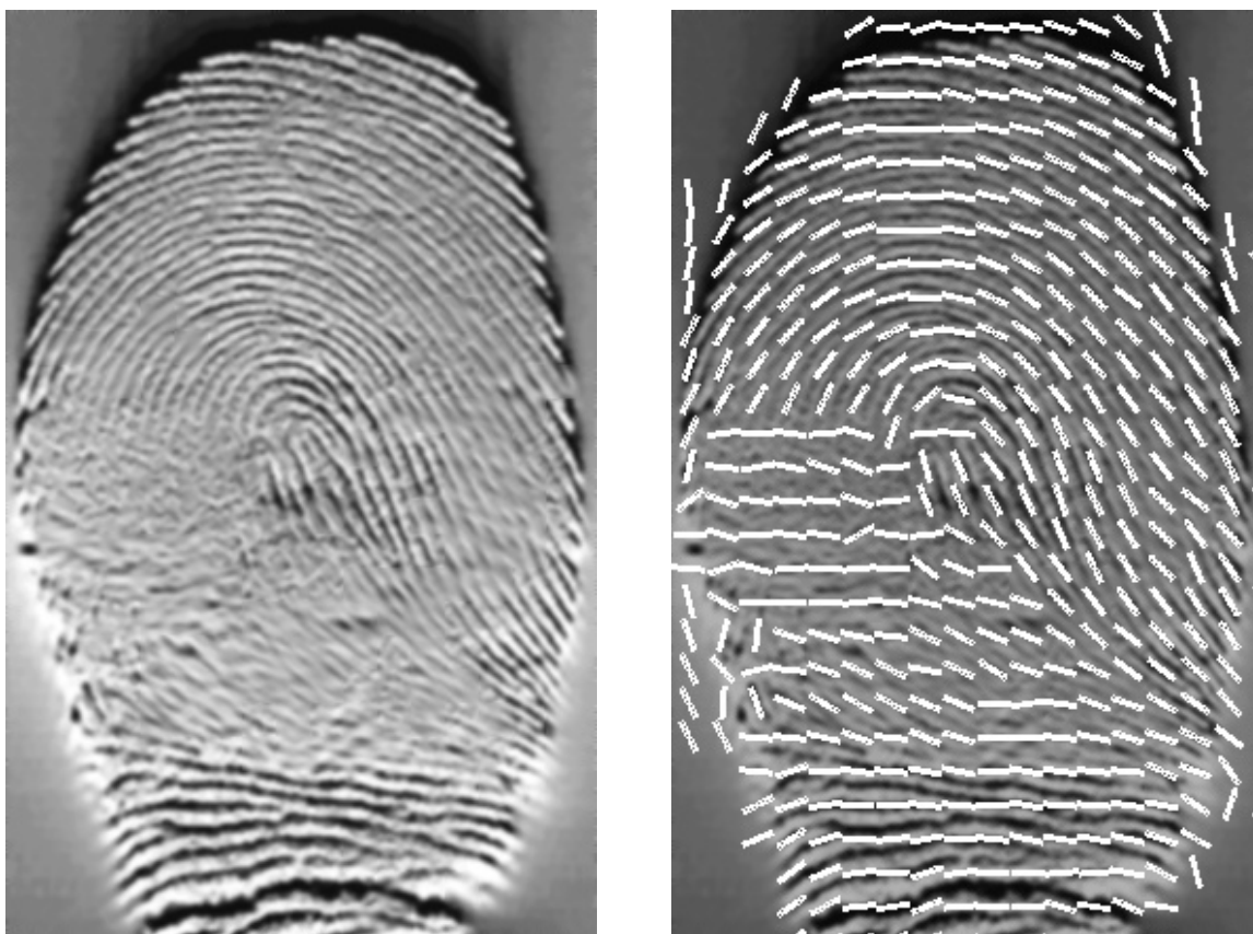
Obrázek 6.5: Příklad otisku, na kterém se nachází poškozené regiony na kterých algoritmus pracoval chybně. Poškozené regiony, nacházející se v levé části otisku, jsou v tomto případě nejspíš způsobeny nečistotou na prstu či snímači nebo nedostatečným přitlakem.
