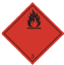
Obr. 5 Hořlavé kapaliny: třída 3
