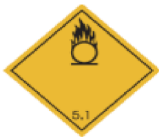
Obr. 9 Látky podporující hoření: třída 5.1
