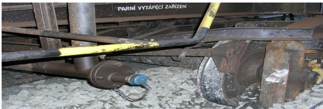
Obr. 2.7 Vykolejený vůz a pohled na nepoškozený koncový uzávěr
