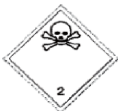
Obr. 4 Toxické plyny: třída 2.3
