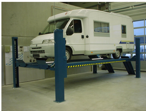
Obrázek 14 - Zvedák pro měření geometrie NUSSBAUM COMBI LIFT 4.65H (zdroj: AD technik Servisní technika)
