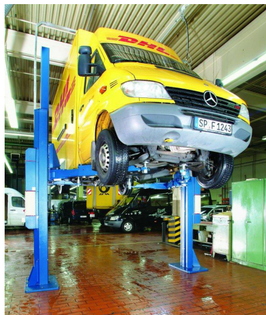
Obrázek 13 - Zvedák Nussbaum Power Lift HDL 6500SST (zdroj: AD technik Servisní technika)
