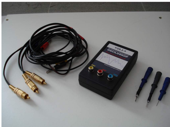
Obrázek 23 - Digitální automobilový osciloskop (zdroj: autor)
