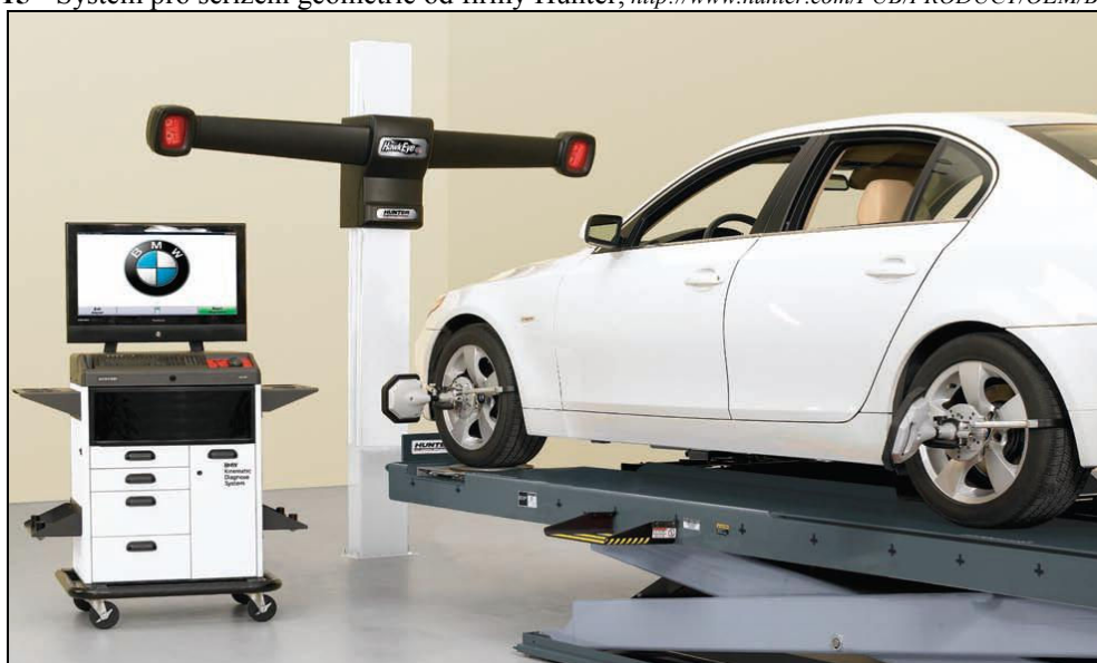
Obrázek 15 - Systém pro seřízení geometrie od firmy Hunter, http://www.hunter.com/PUB/PRODUCT/OEM/BMW/
