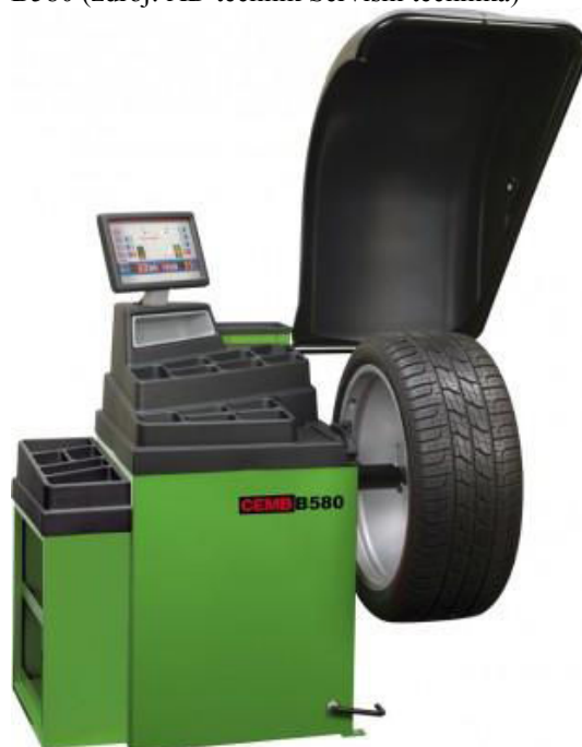
Obrázek 18 - Digitální vyvažovačka CEMB B-line B580 (zdroj: AD technik Servisní technika)
