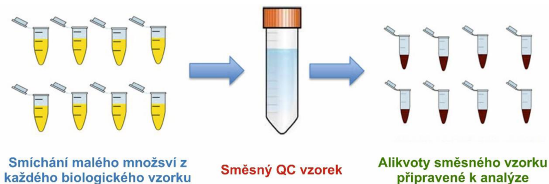
Obrázek 4. Schematické znázornění přípravy směsného vzorku kontroly kvality. Z každého biologického vzorku je odebráno malé množství za vzniku jednoho směsného vzorku, který je poté rozaliquotován pro samotnou analýzu v rámci analytické série. Převzato a upraveno podle Broadhurst a kol. [20].
