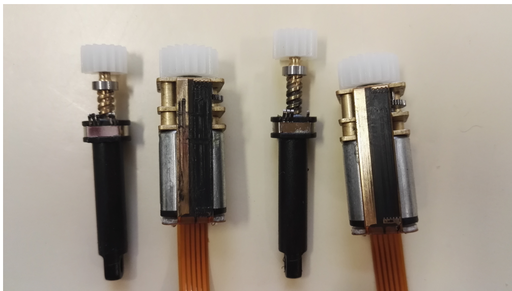
Obrázek 6.2: Servomotory Actuator, servo napravo má viditelné rýhy na lineárním potenciometru
