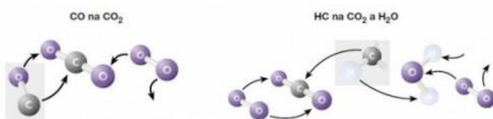
Obrázek 7: Oxidace CO na CO 2 a HC na H 2 O+CO 2
