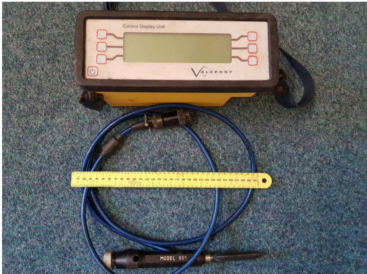
Obr. 7.4 EMI-měřidlo Valeport-Flat model 801 s příslušenstvím
