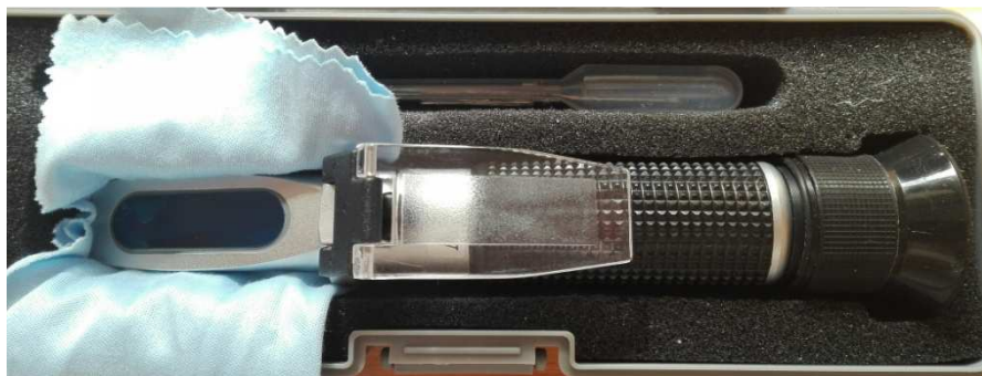
Obr. č. 5 – refraktometr pro určení obsahu vody v medu
