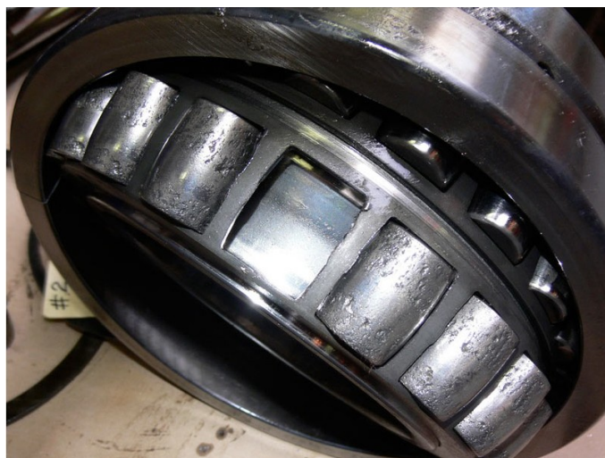
Obr. 2.16 Poškozená valivá tělíska ložiska [28]
