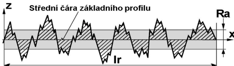
Obr. 2.15 Schéma hodnocení kvality povrchu pomocí parametru R_a [25]
