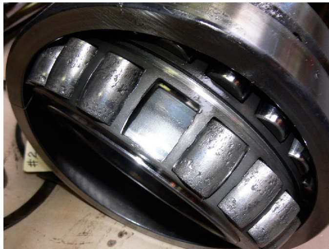
Obr. 2.16 Poškozená valivá tělíska ložiska [28]
