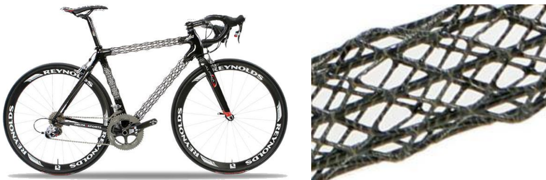
Obr. 21 Rám jízdního kola, včetně detailu jeho struktury
