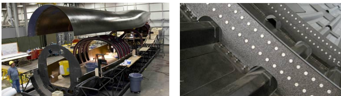
Obr. 18 Trup letadla Boeing, včetně detailu nýtových spojů trupu
