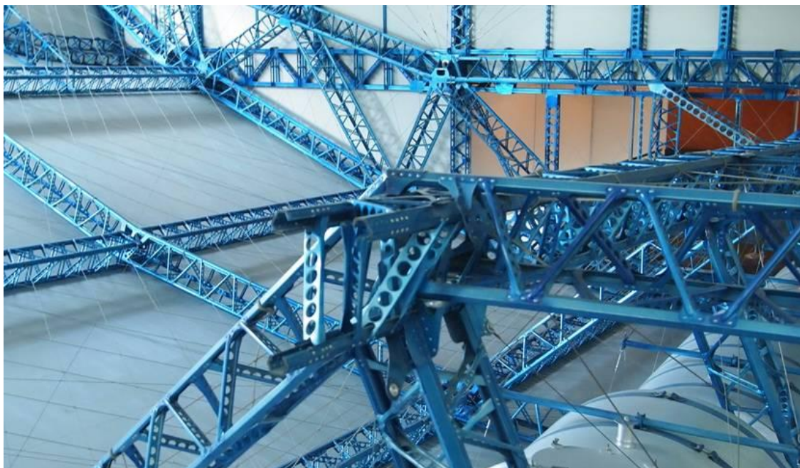
Obr. 26 Odlehčená duralová konstrukce vzducholodi Zeppelin
