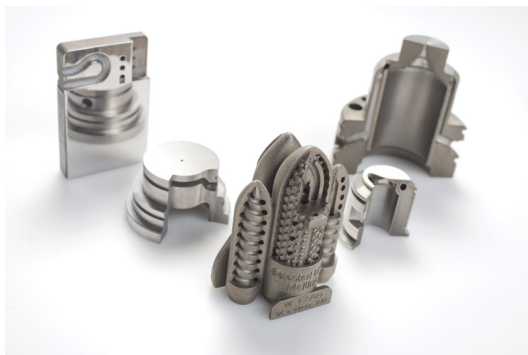
Obrázek 2.2: Produkty vytvořené technologií SLM. [10]
