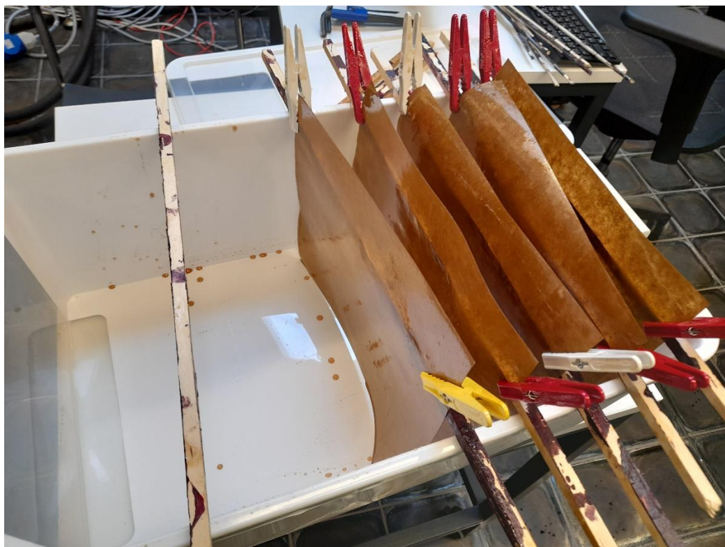
Obrázek 11: Ukázka odstranění přebytků lepidla odkapáním (Vlastní zpracování)
