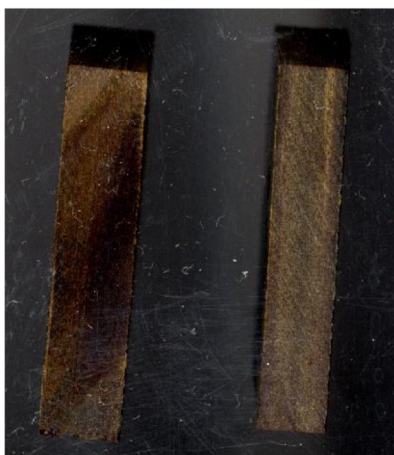
Obrázek 16: Pohled na výskyt vnitřní delaminace laminátů PF-A, PF-B, KLPF-1 a KLPF-5 (Vlastní zpracování)
