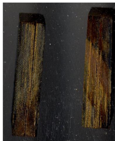
Obrázek 16: Pohled na výskyt vnitřní delaminace laminátů PF-A, PF-B, KLPF-1 a KLPF-5 (Vlastní zpracování)
