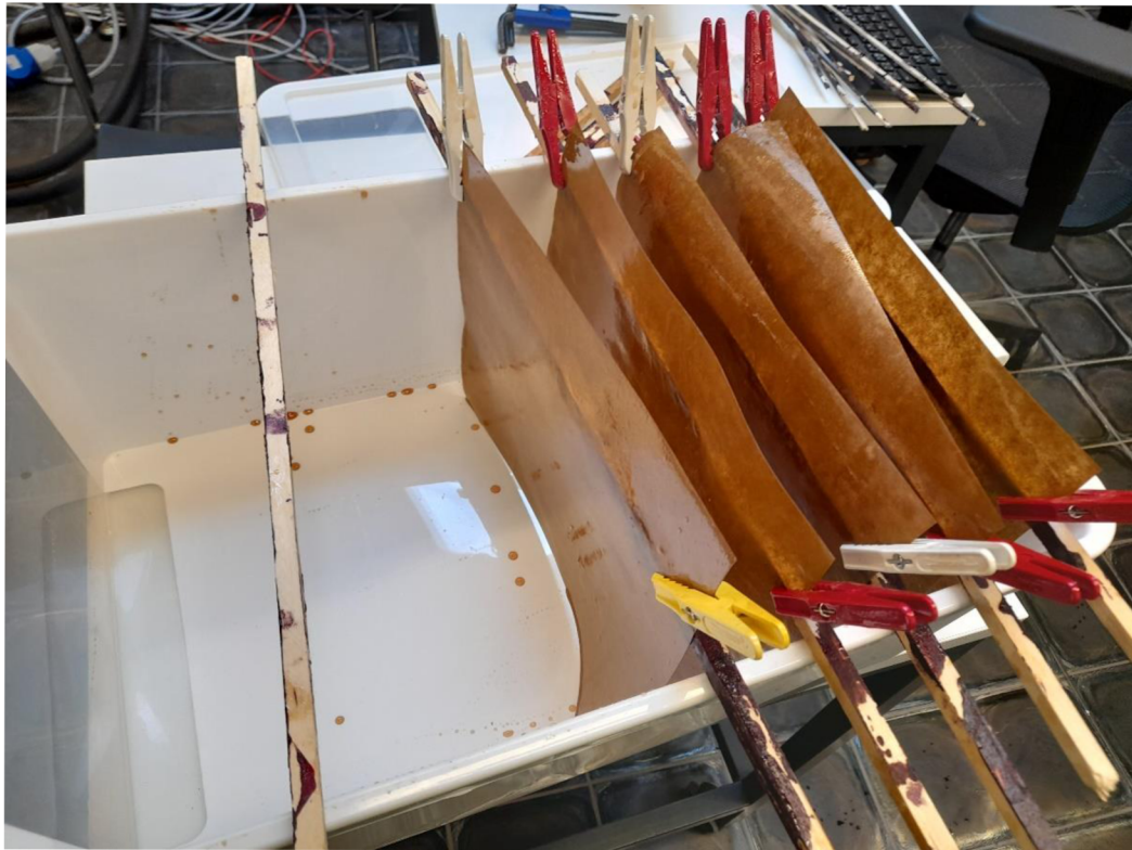
Obrázek 11: Ukázka odstranění přebytků lepidla odkapáním (Vlastní zpracování)
