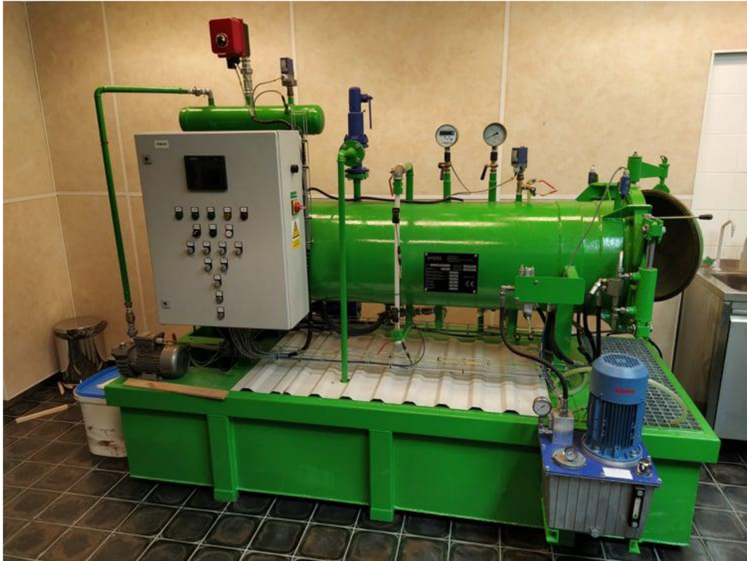
Obrázek 10: Impregnační komora VTIZ 0,5 x 2 VYVOS Spol. s.r.o. (Vlastní zpracování)
