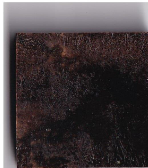
Obrázek 15: Plošný pohled na vysokotlaké lamináty PF-A, PF-B, KLPF-1 a KLPF-5; varianta PF-A zvýrazněn výskyt povrchových trhlin (Vlastní zpracování)
