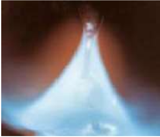
Obr. 2.8 Bezzkratový přenos kovu [10]
