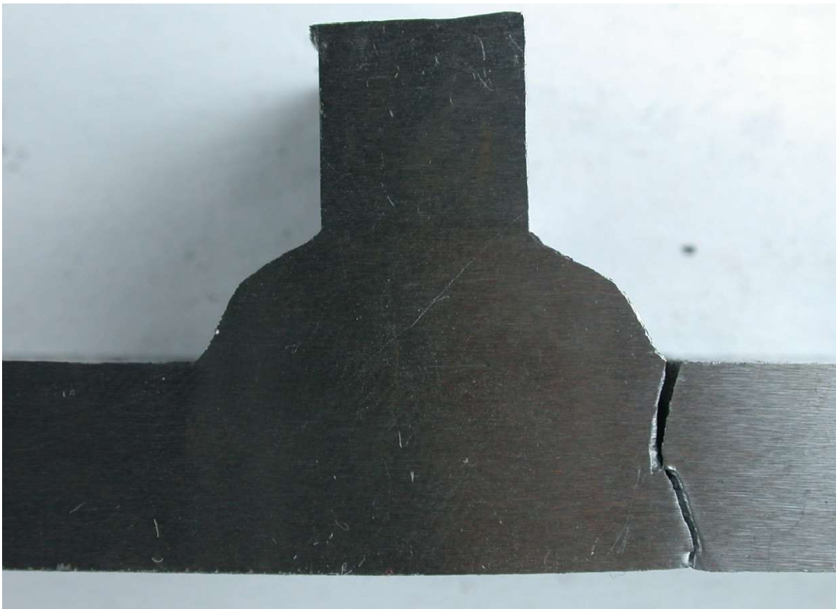
Obr. 3.25 Fotografie poškození vzorku 3 koutového svaru ( R = -1 , \sigma_A = 240 \text{ MPa} , 29245 cyklů)
