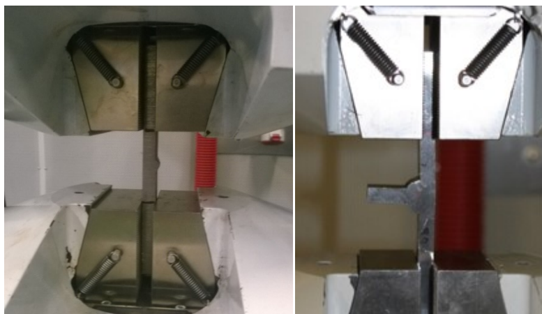
Obr. 3.22 Způsob upnutí obou typů vzorků (tupý svar, koutový svar)
