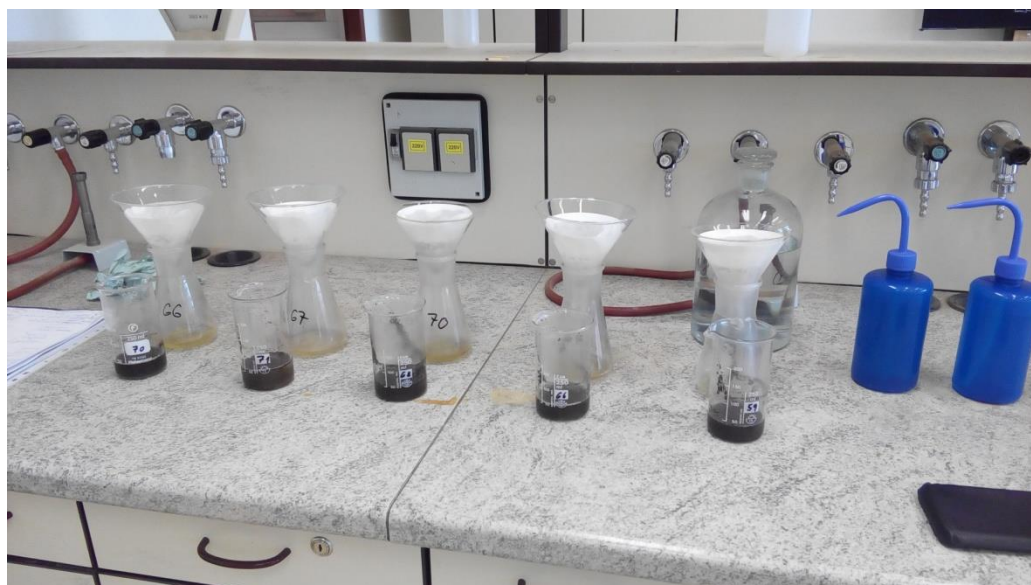
Obrázek č. 10 Promývání substrátu destilovanou vodou (Plucek 2017)
