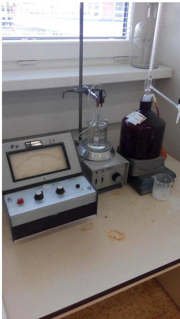
Obrázek č. 10 Promývání substrátu destilovanou vodou (Plucek 2017)
