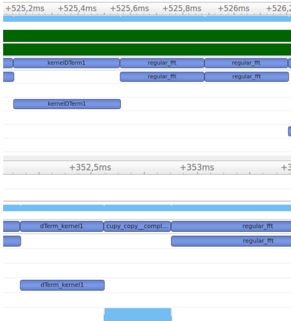
Obrázek 4.2: Příklad vzniku neefektivního kernelu při použití CuPy (dole), oproti implementaci v CUDA (nahore). Mezi výpočtem uživatelského kernelu ( d-term ) a Fourierovy transformace dochází ke vzniku kernelu, který pouze kopíruje data, přestože je výsledek kernelu přímo předán funkci pro odpovídající transformaci a žádné explicitní kopírování voláno není. Během práce na optimalizaci se tento kernel nepodařilo odstranit bez použití explicitní alokace paměti. Zůstává tak hlavním důvodem zpomalení této implementace při základní verzi simulace.
