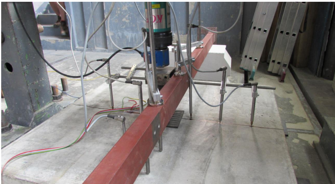
Obr. 3.7: Rozmístění snímačů na horním povrchu testovaných desek
