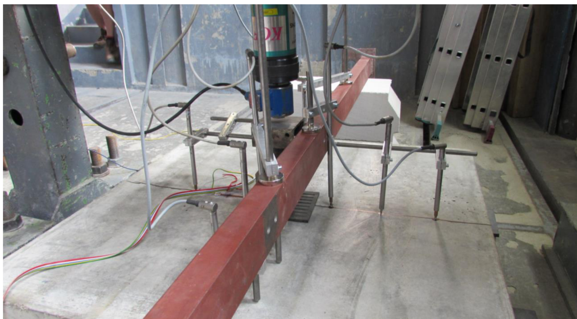
Obr. 3.7: Rozmístění snímačů na horním povrchu testovaných desek
