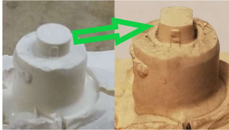
Obrázok 22 Úprava lukoprénovej formy
