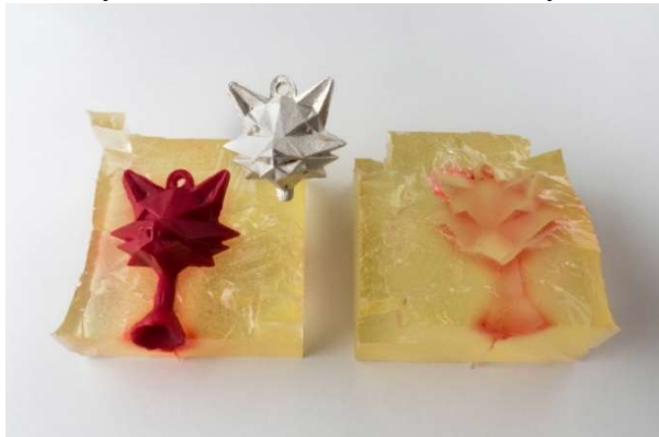
Obrázok 5 Príklad silikónovej formy [13]
