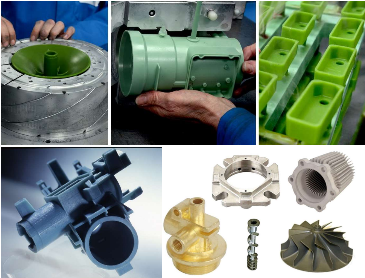
Obrázok 1 Ukážky voskových modelov a finálnych produktov vyrobených technológiou presného odlievania [1] [2] [3]
