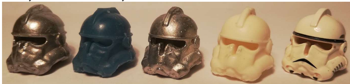
Obrázok 30 Finálne odliatky zľava: Hliník, Vosk, Cín-Olovnatá spájka a Ebalta SG 2000 v porovnaní s referenčnou helmou vpravo
