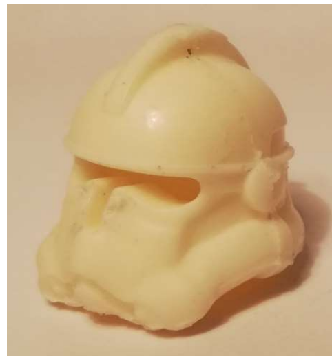
Obrázok 29 Finálny odliatok z dvojzložkovej živice
