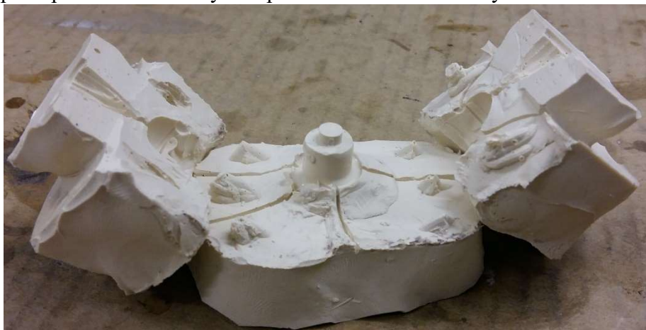
Obrázok 19 Lukoprénová forma rozložená
