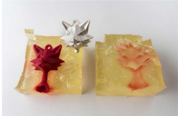
Obrázok 5 Príklad silikónovej formy [13]
