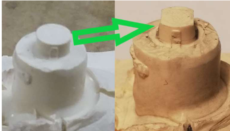
Obrázok 22 Úprava lukoprénovej formy
