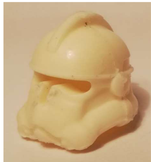
Obrázok 29 Finálny odliatok z dvojzložkovej živice
