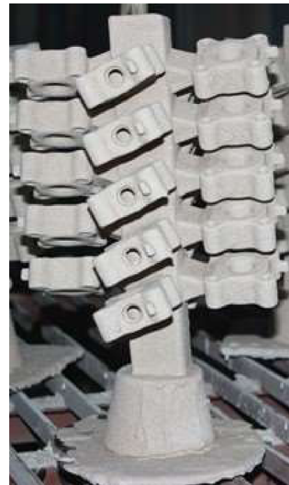
Obrázok 9 Stromček obalený primárnym obalom [18]
