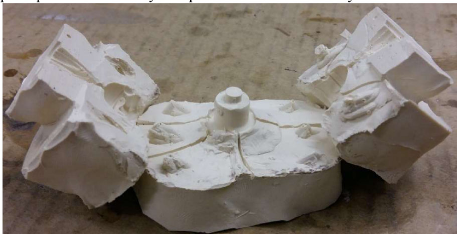
Obrázok 19 Lukoprénová forma rozložená
