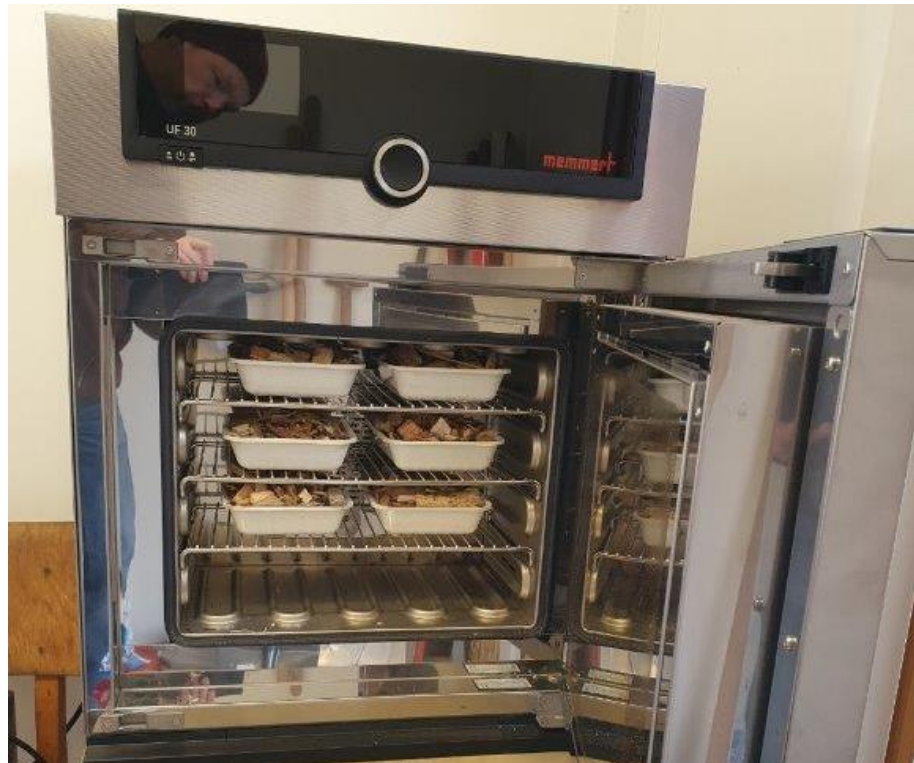
Obr. 6: Sušení vzorků dřevní štěpky (Foto autor, 2019)
