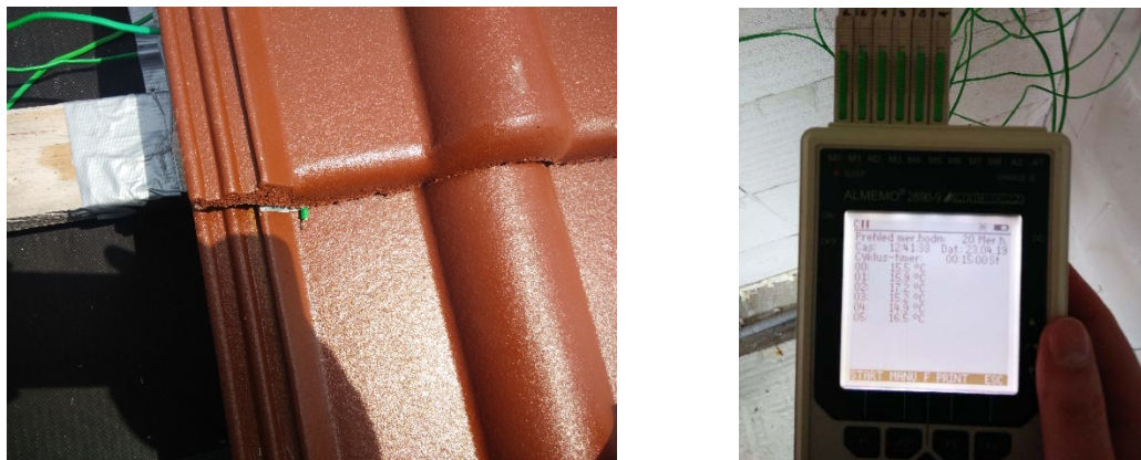
Obr. 23 Zakrytí termočláneku na horním povrchu krytiny následující řadou tašek+sběr dat [32]
