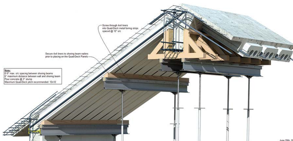
Obr. 1 Disaster-resistant konstrukce šikmé hmotné střešy [28]
