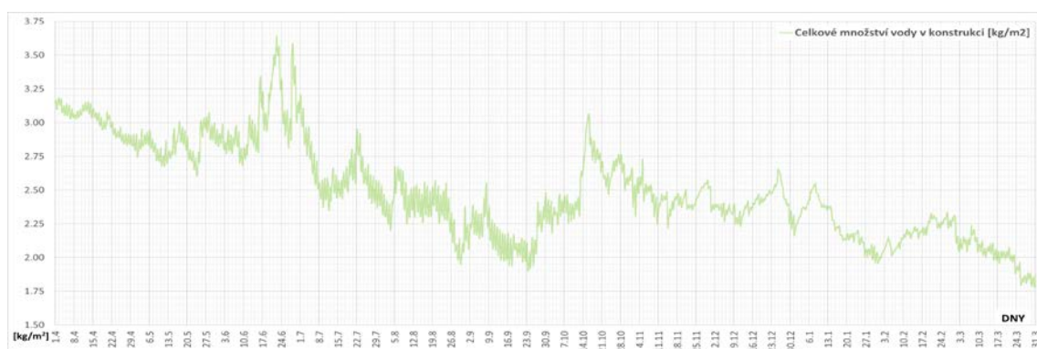
Graf 29 Celkové množství vody v konstrukci skladby [32]
