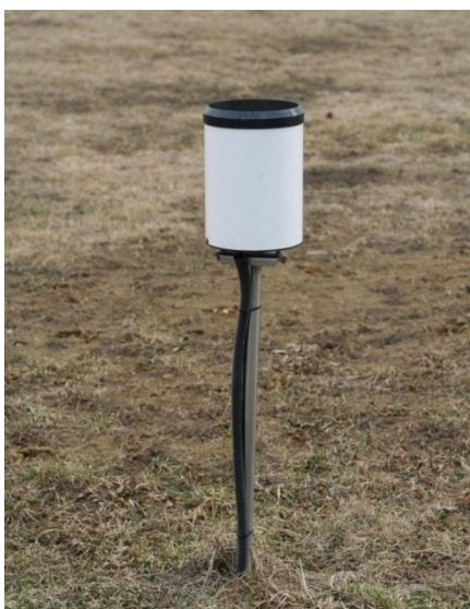
Obr. 5 Srážkoměr Fiedler SR02 (M. Kulczycki, 11. 3. 2011)
