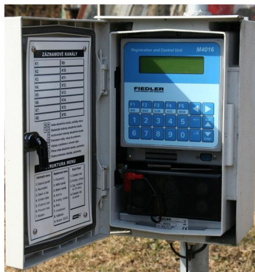
Obr. 6 Univerzální řídicí jednotka M4016 (M. Kulczycki, 12. 3 2011)
