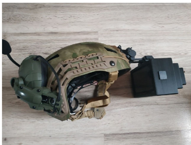
Obrázek 47: Aplikování nočního pozorovacího systému na náhlavní soupravu
