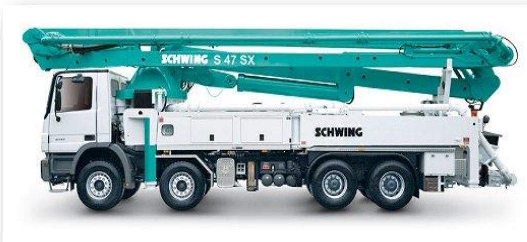
Obr. 7.4. Autočerpadlo Schwing S47 SX
