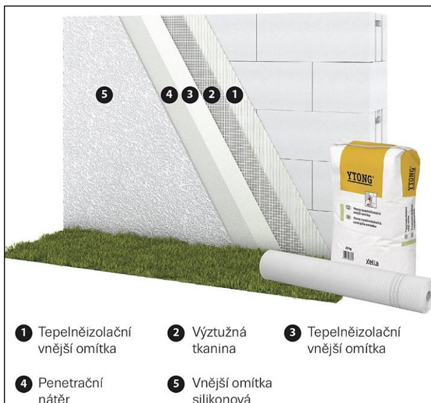
Obr. č. 18 – Řešení s tepelněizolační omítkou (44)
