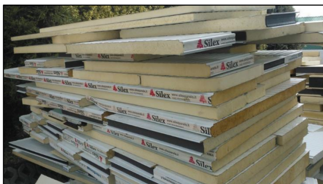
Obr. č. 5 – Izolační PUR panel (29)
