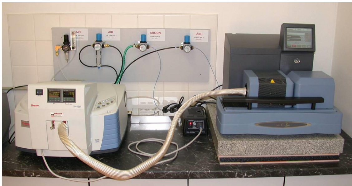
Obrázek 11: Simultánní termogravimetrický, diferenčně termický analyzátor s efluenční plynovou analýzou Q600 od firmy TA INSTRUMENTS s infračerveným analyzátozem THERMO NICOLET IS10
