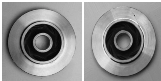
Obr. 6.4: Zobrazenie príkladov z datasetu Industry circles (na ľavo správne, na pravo poškodené)
