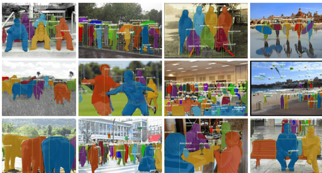
Obr. 2.7: Príklady segmentácie inštancií Mask R-CNN [14]
