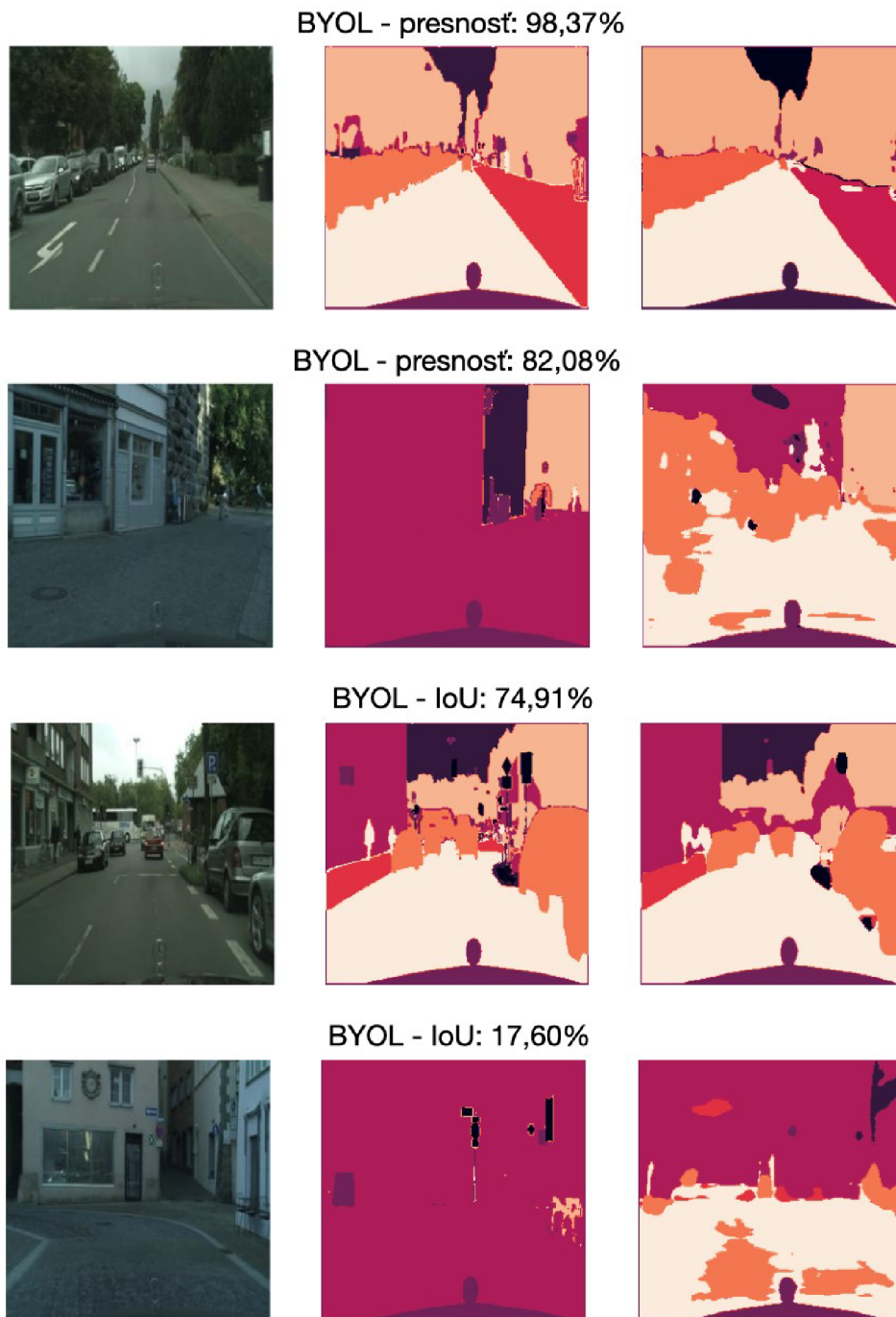
Obr. C.5: Enkóder predtrénovaný SSL metódou BYOL. Vyhodnotenie najlepšej a najhoršej presnosti a IoU. Na ľavo vstupný obrázok, v strede označenie tried masky, na pravo predikovaná maska.
