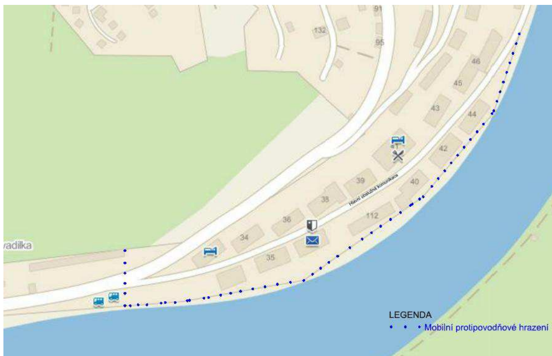
Obrázek č.10: Mapa znázorňující umístění mobilních protipovodňových hrazení, zdroj: (5)
