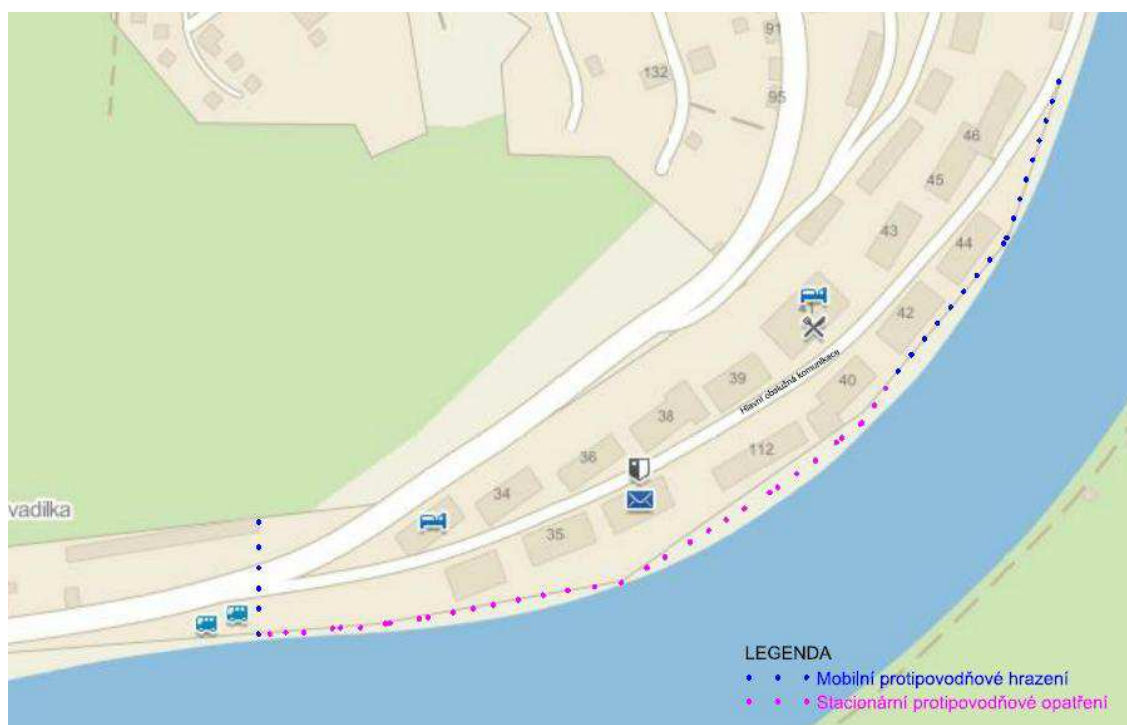
Obrázek č.11: Mapa znázorňující umístění kombinace mobilních a stacionární protipovodňových opatření, zdroj: (5)
