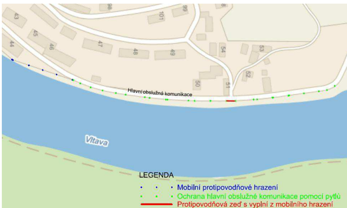
Obrázek č.14: Mapa možné ochrany křížení hlavní obslužné komunikace s místní komunikací u č.p.51, zdroj: (5)
