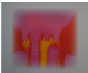
Obrázek 33: Snímek ze 3D kamery skenující pozice struků, spol. GEA (zdroj: materiály spol. GEA)
