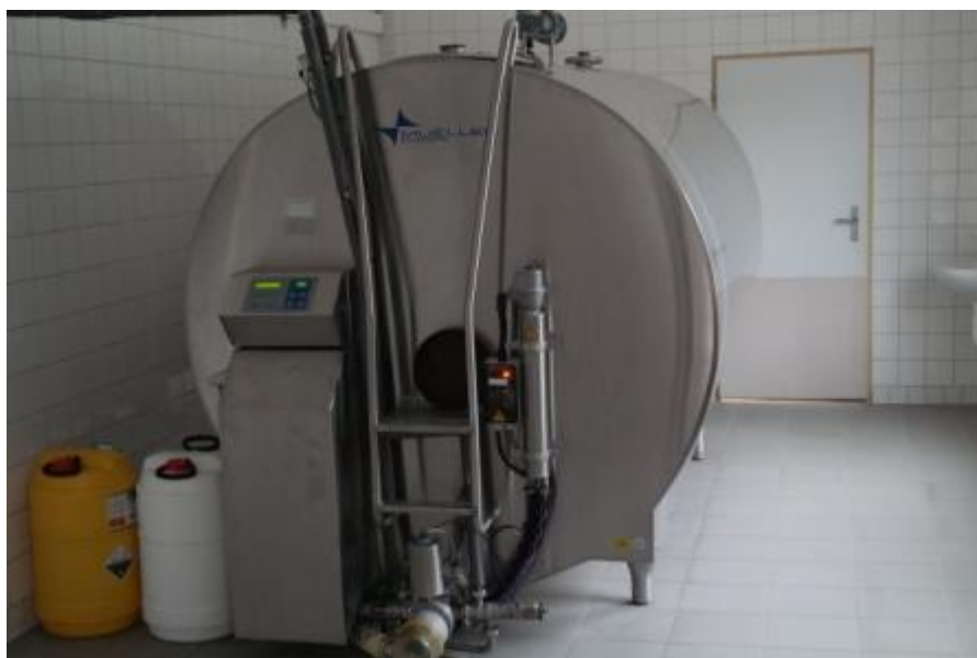
Obrázek 16: Mléčnice s chladicí jednotkou (zdroj: autor)
