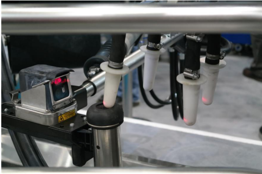
Obrázek 49: Navádění strukových násadců pomocí laseru; DeLaval VMS (zdroj: autor)
