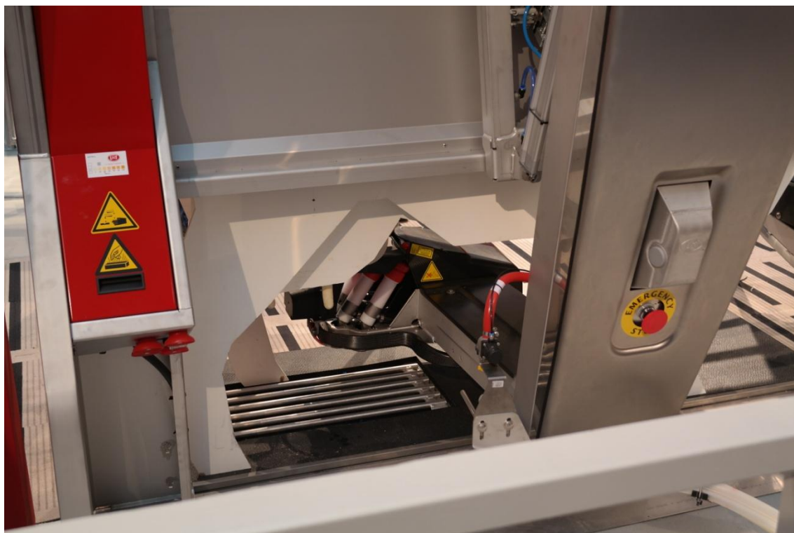
Obrázek 47: Robotické rameno Lely, nesoucí pouzdro se strukovými násadci (zdroj: autor)
