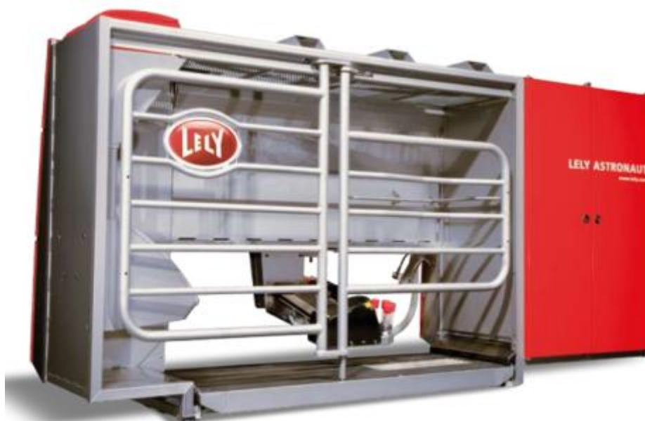
Obrázek 28: Dojící robot Lely A3 ( www.lely.com , 2015)
