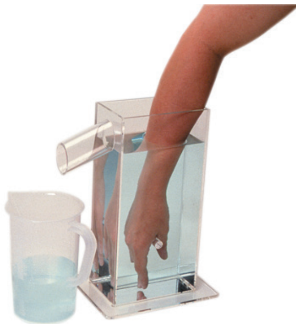
Obrázek 1: Měření objemu na základě Archimédova zákona, převzato z [17].
