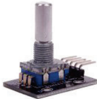
Obrázek 13: Modul s rotačním enkodérem KY-040, převzato z [10].
