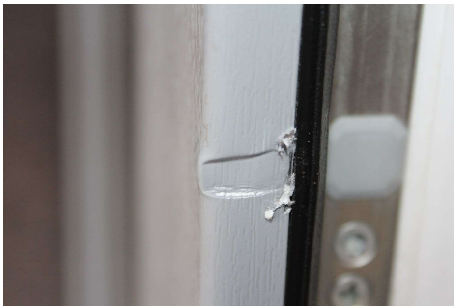
Obr. č. 15: Vtisky po nástroji na vypáčeném okně – vlastní obrázek. Zdroj: (kriminalistický spis KŘP Havlíčkův Brod).
