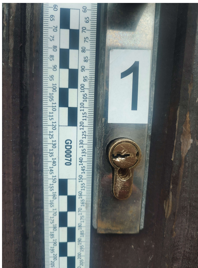
Obr. č. 30: Odvrtaná cylindrická vložka – vlastní obrázek. Zdroj: (kriminalistický spis KŘP Havlíčkův Brod).
