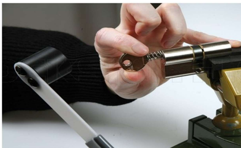
Obr. č. 25: Ukázka použití metody BUMP KEY. Zdroj: ( https://www.locksmith.cz/cs/bump-keys/flexihammer-no-1-2900.html ).
