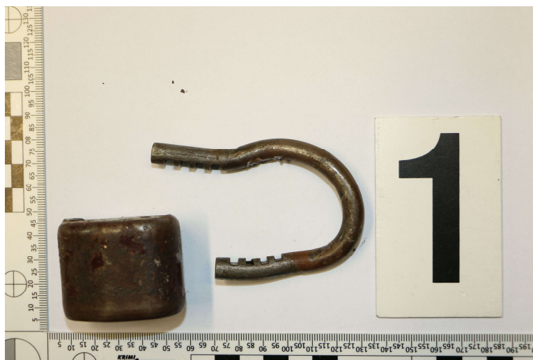
Obr. č. 32: Vypáčený třmen visacího zámku – vlastní obrázek. Zdroj: (kriminalistický spis KŘP Havlíčkův Brod).
