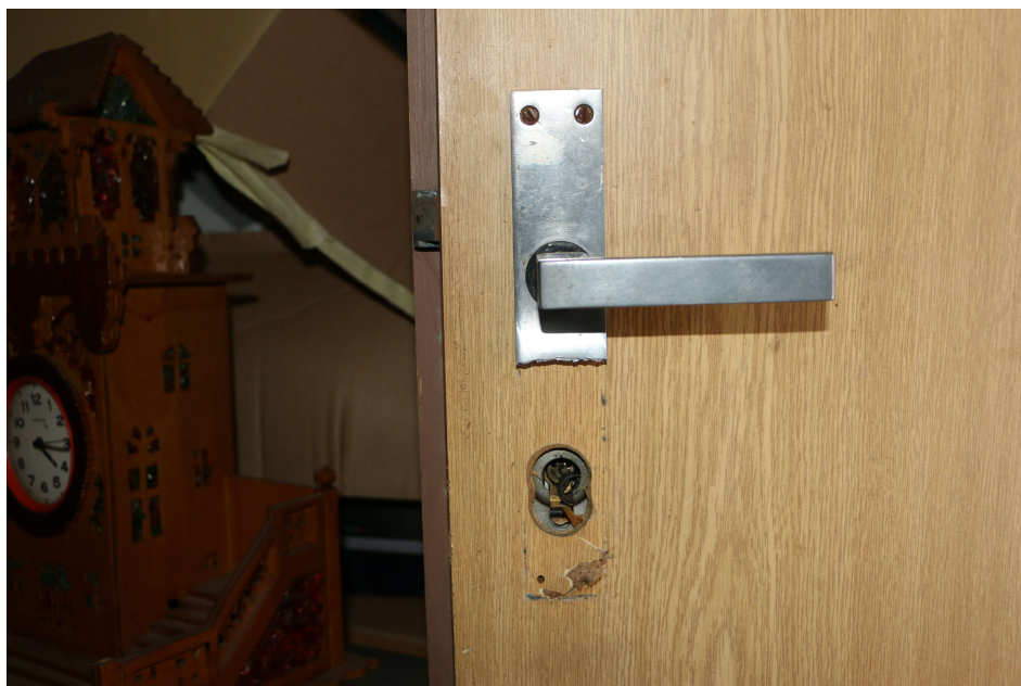
Obr. č. 28: Pohled na rozlomenou cylindrickou – vlastní obrázek. Zdroj: (kriminalistický spis KŘP Havlíčkův Brod).
