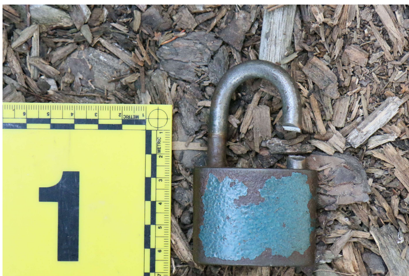
Obr. č. 31: Přestřížený třmen visacího zámku – vlastní obrázek. Zdroj: (kriminalistický spis KŘP Havlíčkův Brod).
