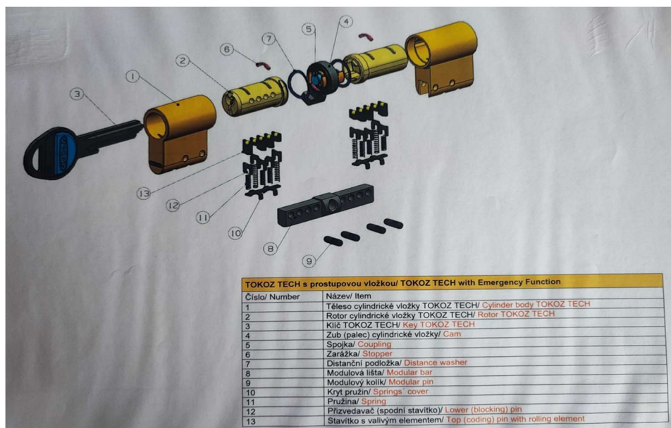
Obr. č. 40: Cylindrická vložka TOKOZ TECH. Zdroj: (autor práce ve firmě Tokoz, a.s.).
