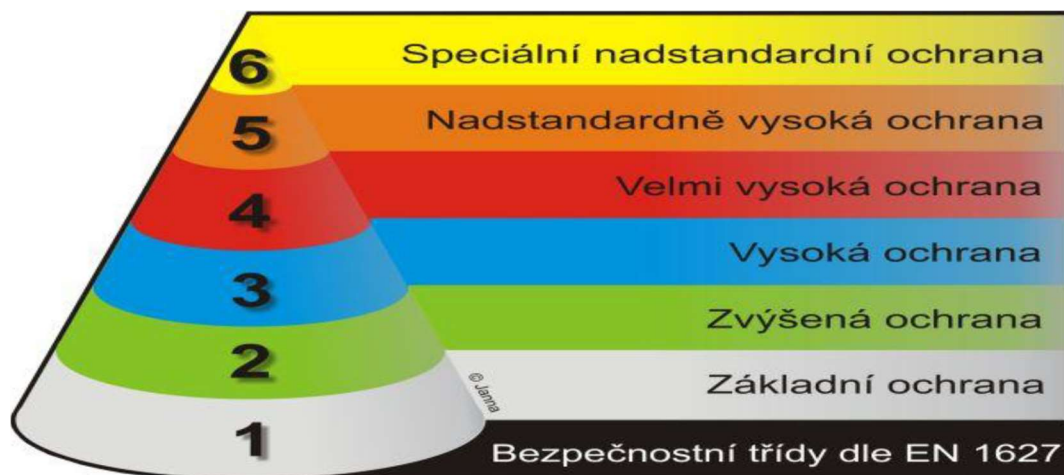
Obr. č. 12: Stupně odolnosti. Zdroj: ( https://stavba.tzb-info.cz/dvere/21651-bezpecnostni-dvere-do-bytovych-domu ).
