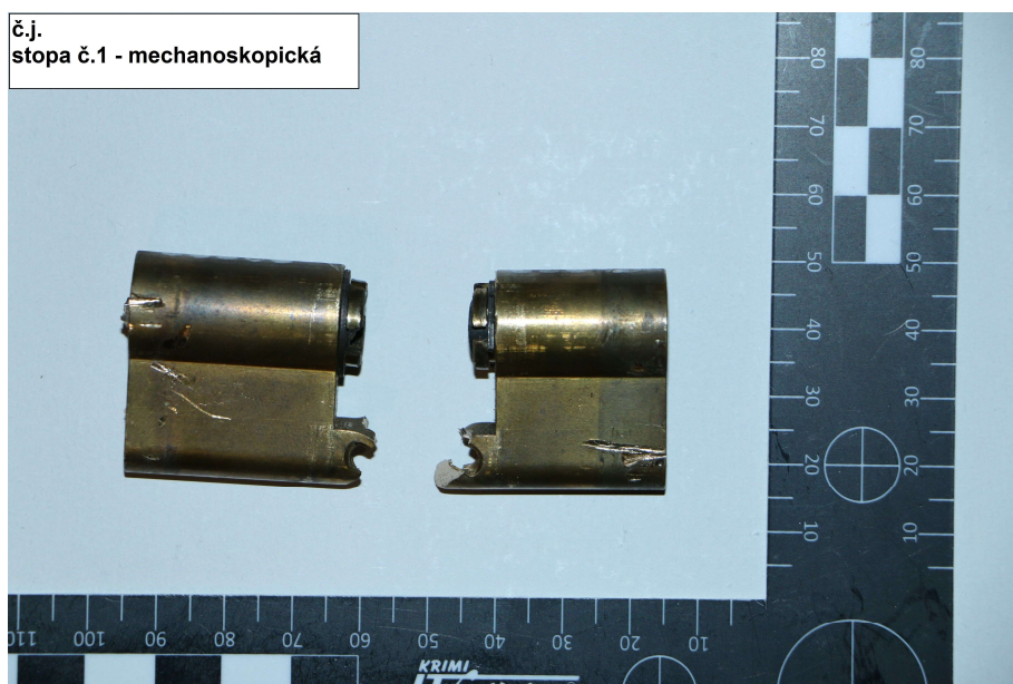
Obr. č. 29: Rozlomená cylindrická vložka – vlastní obrázek. Zdroj: (kriminalistický spis KŘP Havlíčkův Brod).
