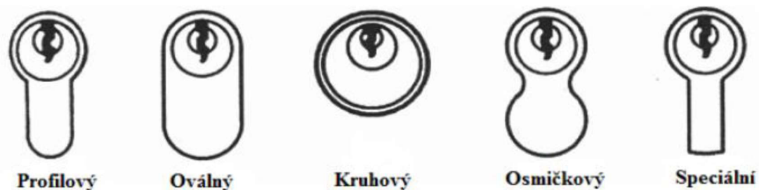
Obr. č. 9: Tvary těles cylindrických vložek. Zdroj: (UHLÁŘ, J. Technická ochrana objektů I. díl: Mechanické zábranné systémy II. Praha: Vydavatelství PA ČR, 2004. s. 93. ISBN 978-80-7251-312-3).
