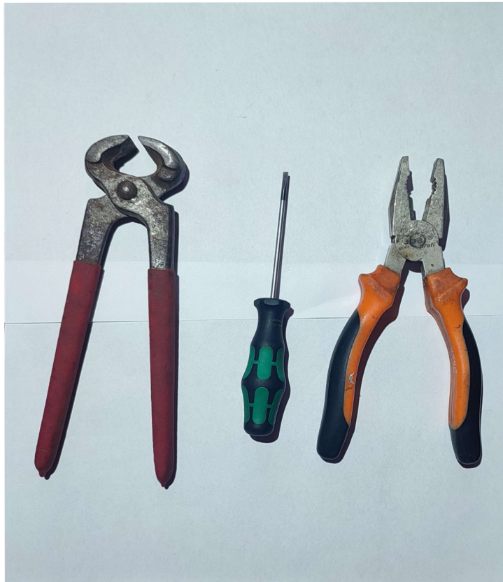
Obr. č. 13: Sériově vyráběné nástroje (štípací kleště, šroubovák a kombinované kleště). Zdroj: (autor práce).
