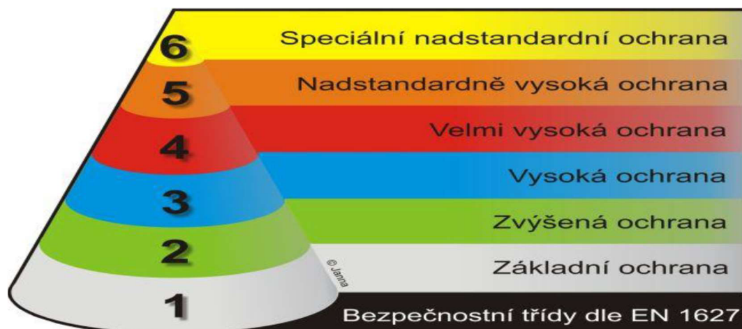
Obr. č. 12: Stupně odolnosti. Zdroj: ( https://stavba.tzb-info.cz/dvere/21651-bezpecnostni-dvere-do-bytovych-domu ).
