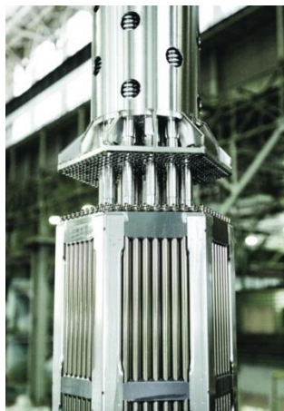
Obr. 3-7 Detail horní části palivového článku VVER 1000 [11]
